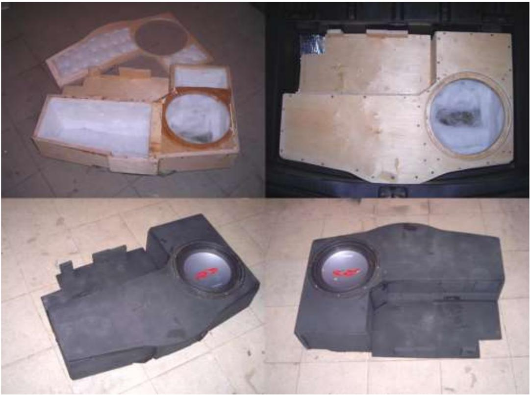
Изготовление каркаса корпуса в нишу запасного колеса
