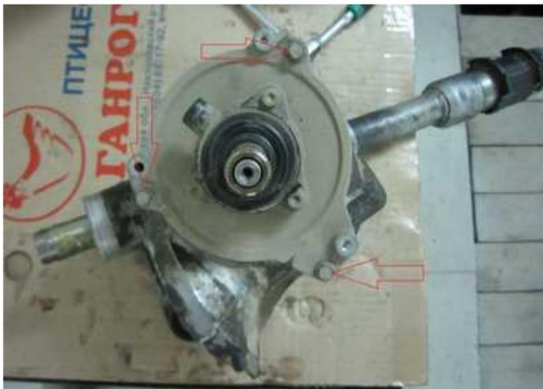
Далее снимаем крышку редуктора. Он крепится тремя болтами М6 (головка на 10 мм). -Снимаем крышку редуктора
