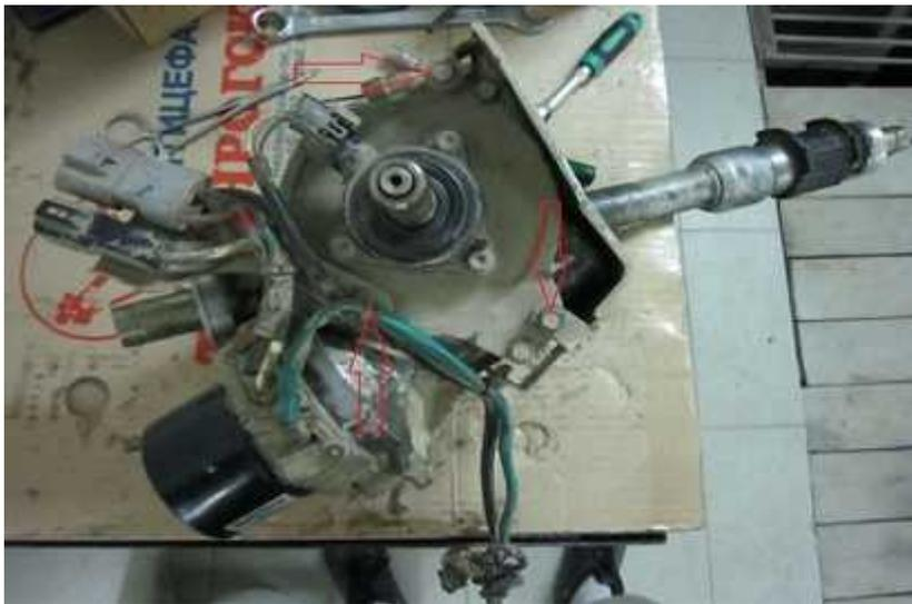
Снимаете все кронштейны с разъемами и проводами, откручивая три болта М6 (головка на 10 мм) с крышки редуктора (показано стрелками).
