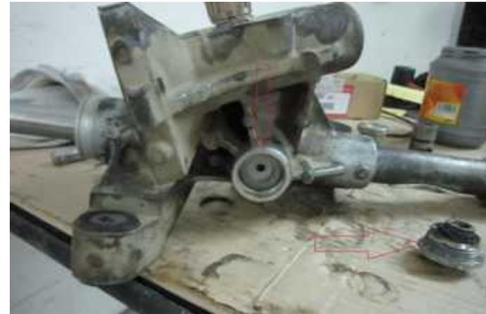
Наконец вам останется выкрутить гайку пружинного подпора рейки и вытащить сам подпор. ( У меня он был сильно изношен и я его заменил на новый). **-Пружинный подпор**
