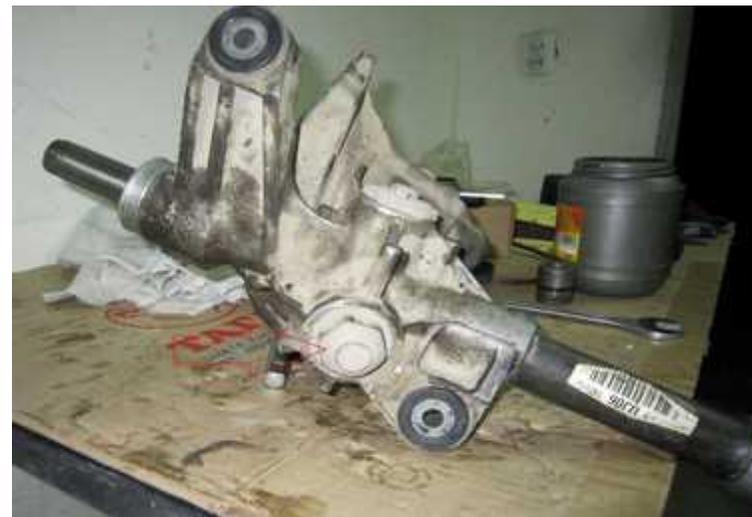
Далее вы демонтируете вал-шестерню с червячным колесом. Для этого вы откручиваете крышку ключом на 32, под ней располагается упорная гайка откручиваете ее ключом на 19 после чего легко вынимаете вал-шестерню. Только аккуратнее с подшипниками! -Откручиваем крышку
