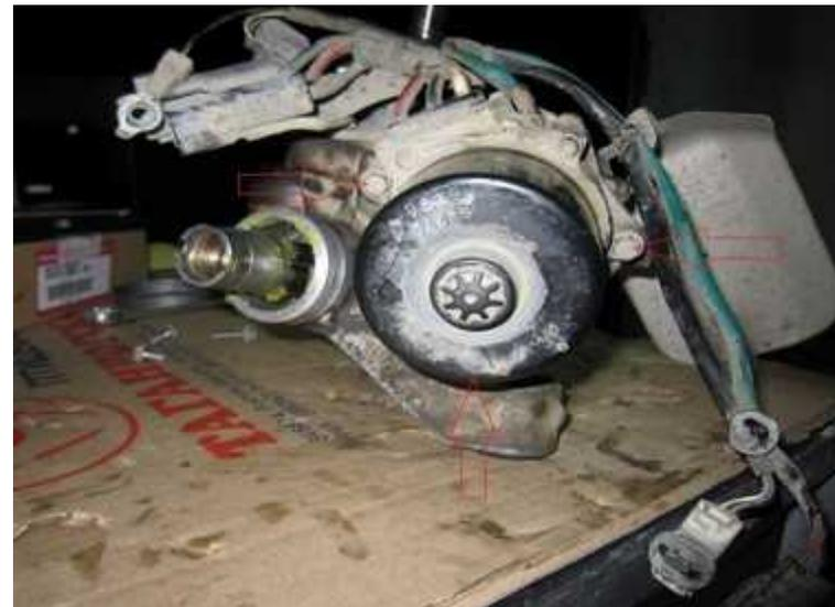
Откручиваете электродвигатель электроусилителя. -Откручиваем три болта М6 (головка на 10 мм) на электродвигателе
